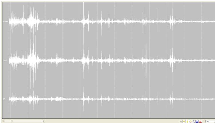
Figura 1: Esempio di acquisizione di microtremori nel campo delle velocità secondo le tre componenti (X,Y,Z)
